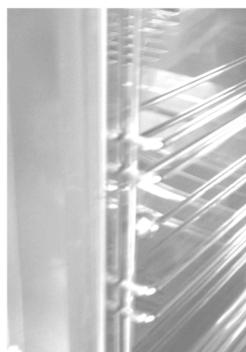
Pour le démontage des échelles, positionner les doigts comme indiqué sur la photo de façon à exercer une légère traction, et pousser avec les pouces comme indiqué sur la seconde photo.
